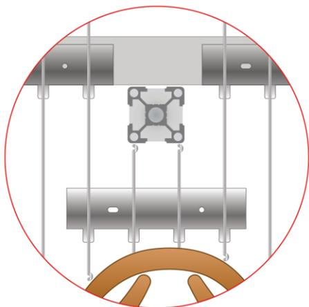
Apposite dime sono presenti nella confezione e indicano precisamente le posizioni dove collocare la barriera. Questo posizionamento preciso consentirà di ottimizzare l'installazione della barriera al di sotto dei profili e ottenere la perfetta chiusura del vano. (vedi esempio sottostante)
