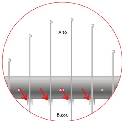
**3.7.2** Utilizzare come riferimento lo spigolo inferiore della cornice in alluminio del pannello fotovoltaico per appoggiare la barriera ed effettuare l'applicazione (vedi esempio sottostante).
